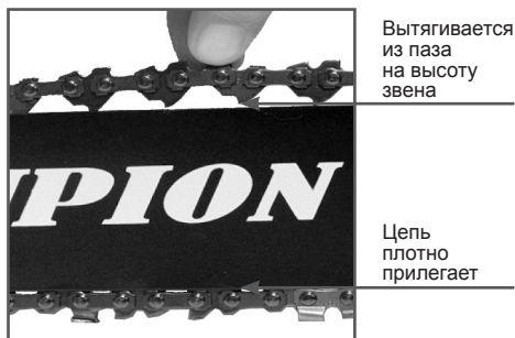
Рис. 5 Регулировка натяжения цепи
