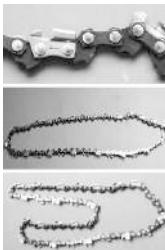
имеет хорошую прочность, остро заточенные режущие зубья. На поверхности цепи указано направление движения. При каждом использовании цепи необходимо обращать внимание на направление вращения цепи.
