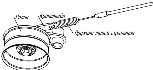
Рис.6. Схема зацепления троса сцепления с кронштейном
