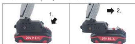
Чтобы извлечь аккумуляторную батарею , нажмите на кнопку разблокировки и извлеките аккумулятор из электроинструмента.
